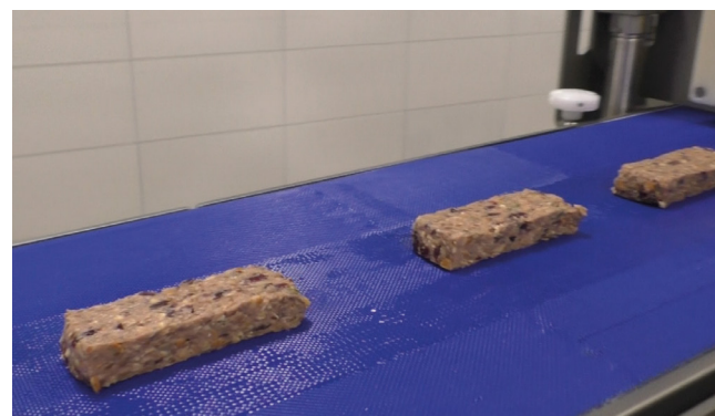
↑ Режущее устройство SE 442 (производитель: Handtmann) для автоматического однополосного производства веганских формованных продуктов. На рисунке изображено производство веганских палочек.
