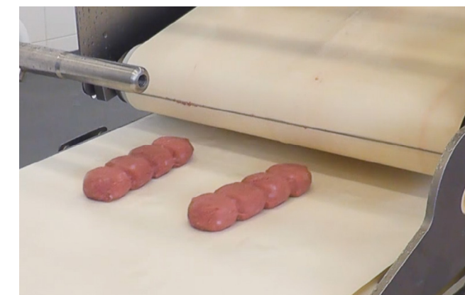
↑ Формующая система FS 522 (производитель: Handtmann) с запатентованной системой с 3-мя ножевыми пластинами для автоматического двухполосного производства веганских формованных продуктов. На рисунке показано свободное формование веганских сегментированных роллов, которые затем прикатываются до формы, напоминающей Адана кебаб.
