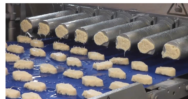
↑ Формующая система FS 510 (производитель: Handtmann) для автоматического 6-24-полосного производства веганских формованных продуктов. На рисунке изображено производство веганских наггетсов с помощью трубок, придающих необходимую форму.
