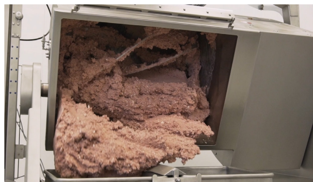
↑ Выгрузка готового веганского фарша после смешивания (мешалка Inotec VarioMix (слева) и крупный план веганского фарша с белыми частицами кокосового жира (справа). Источник: Handtmann
