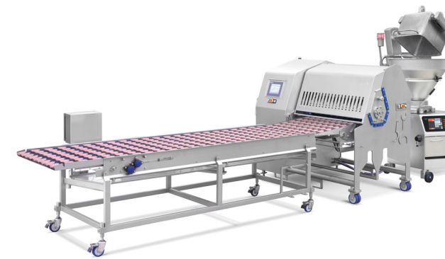
↑ Барабанная формующая машина GEA MaxiFormer (производитель: GEA) для многополосного производства веганских формованных продуктов. На рисунке показано производство веганских наггетсов.
