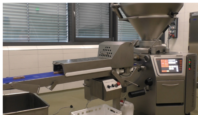
↑ Режущее устройство SE 442 (производитель: Handtmann) для автоматического однополосного производства веганских формованных продуктов. На рисунке изображено производство веганских палочек.
