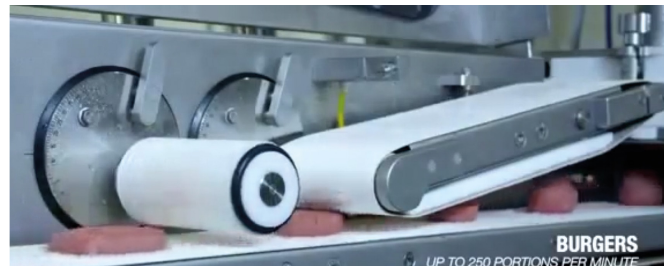
↑ Формующая система MBF-1 (производитель: Verbufa) для автоматического однополосного производства веганских формованных продуктов. На рисунке показано производство веганских котлет для бургеров с помощью прикатывающего транспортера и перфорирующего ролика.
