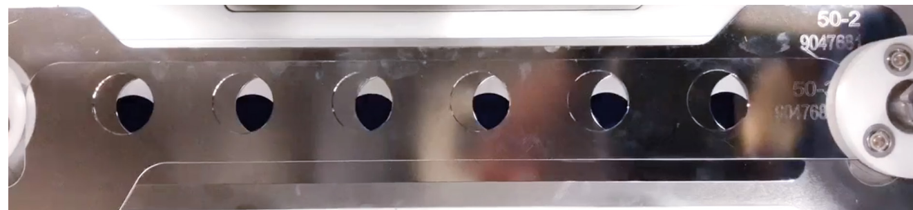
↑ Формующее и режущее устройство формующей системы Handtmann для свободного формования (FS 520, FS 521, FS 522). Оно состоит из наложенных друг на друга ножевых пластин, которые двигаются по круговым траекториям. Эта запатентованная технология позволяет производить трехмерные продукты произвольной формы с круглым сечением (например, шарики, цилиндры, овалы, конусы, диски, сегментированные цилиндры).
