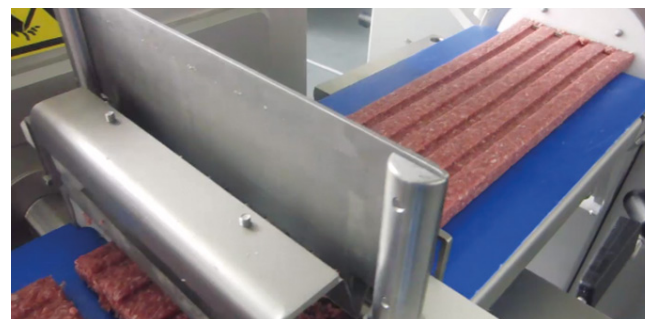
↑ Линия Handtmann с GMD 99-3 (или GMD 99-2) для веганского фарша используется для автоматического однополосного производства веганских формованных продуктов. На рисунках изображено производство веганского фарша (слева сверху), веганских чевапчичи (справа сверху), веганских твистеров из фарша (слева снизу) и веганских рыб бургеров (справа снизу).
