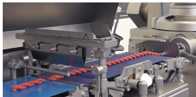
↑ Линия Handtmann с GMD 99-3 (или GMD 99-2) для веганского фарша используется для автоматического однополосного производства веганских формованных продуктов. На рисунках изображено производство веганского фарша (слева сверху), веганских чевапчичи (справа сверху), веганских твистеров из фарша (слева снизу) и веганских рыб бургеров (справа снизу).
