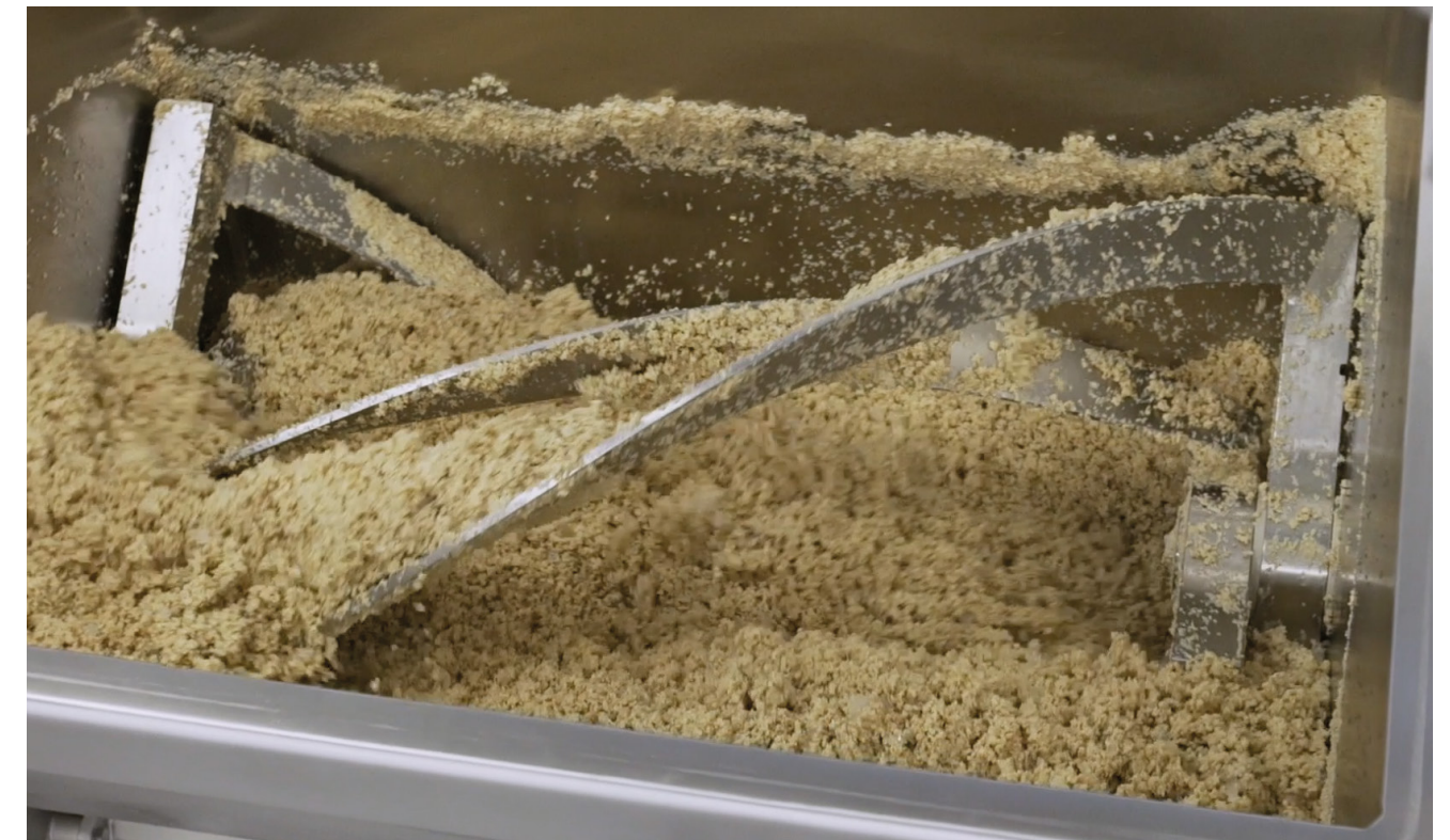
↑ Эффективная гидратация текстуратов сухого белка и волокон в мешалке (Inotec VarioMix - IVM).
