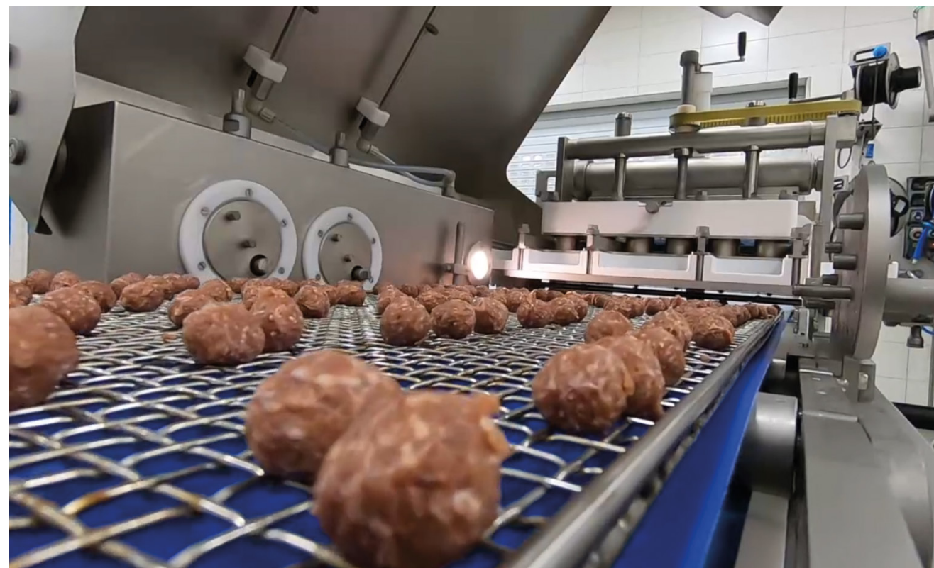
↑ Формующая система Handtmann FS 520 для автоматического многополосного производства веганских формованных продуктов. На рисунке показано 6-полосное производство веганских шариков с прямым размещением в контейнеры.
