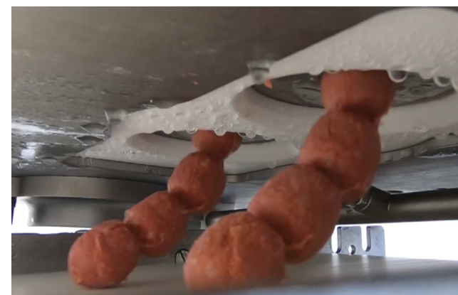
↑ Формующая система FS 522 (производитель: Handtmann) с запатентованной системой с 3-мя ножевыми пластинами для автоматического двухполосного производства веганских формованных продуктов. На рисунке показано свободное формование веганских сегментированных роллов, которые затем прикатываются до формы, напоминающей Адана кебаб.
